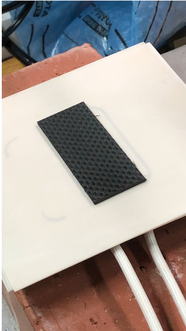
CFRTPの誘導加熱の様子
