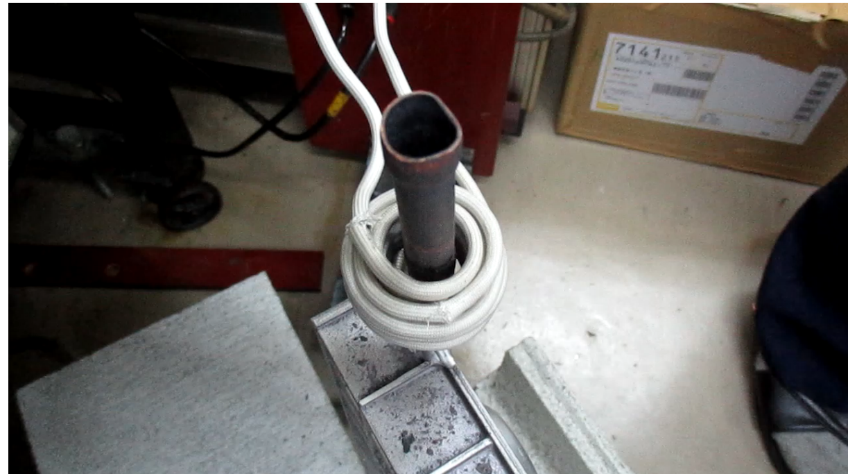
筒状誘導加コイル (熱交換器リングはんだ加熱・溶融)
