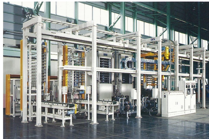
PCB・FPC成形用真空プレス装置
