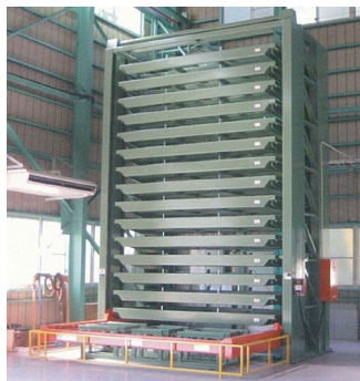
鋼板・鋼材ストッカー
