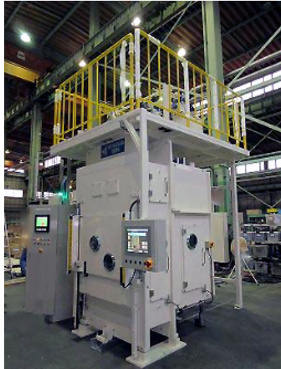
熱可塑性樹脂シート成形用真空プレス
